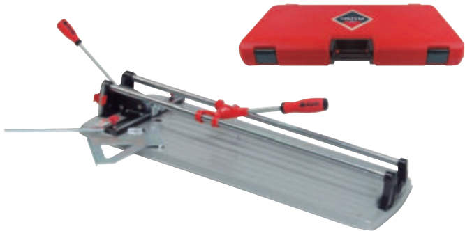
TALLADOR DE CERÀMICA TS-66 MAX GREY 9691033 Longitud de tall: 66 cm, tall diagonal 46 x 46 cm, gruix de tall 6-15 mm, separador monopunt de 800 kg de potència progressiva. Doble guia d'acer cromada. Base de grans dimensions reforçada. Topall lateral per a realitzar talls repetitius rectes i a 45°. Amb rodets de Ø 6 i 10 mm i maleta-estoig inclosos.
