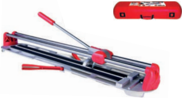
TALLADOR MANUAL CERÀMICA STAR 63 Amb separador mòbil. Amb rodeta de 6mm inclosa. Base amb efecte amortidor. 63 cm de longitud de tall. Gruix de tall 12 mm.
