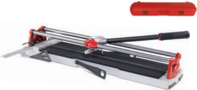
TALLADOR MANUAL PROFESSIONAL SPEED – 92 MAGNET AMB MALETA 9706677 Longitud de tall: 92 cm. Potència separador 800 kg. Màncr reforçat amb empenyadura SOFT-GRIP. Topall lateral mil·limetrat per a talls repetitius i esquadra a 45°. Rodeta Ø 8 mm inclosa.
