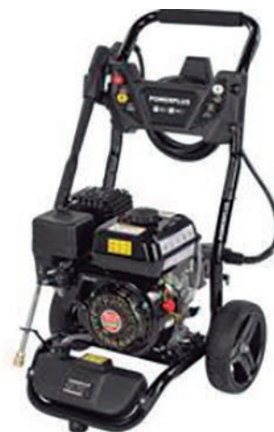
HIDRONETEJADORA A GASOLINA 23002094 Potència 5.1 Kw, pressió nominal 170 bar i màx 255 bar. Cabal màx 540 l/h. Longitud de la mànega 8 m.
