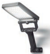
APLIC LED SOLAR CARVALHO 23019559 500lm sensor crep. 10h ip54 d/moviment 4000k 120° bateria reemp. 25m2.
