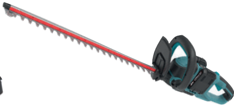
TALLABARDERS A BATERIA 9714293 Amb 2 bateries de 18 v, mànec posterior giratori de 5 posicions per a millors talls verticals, fulla de doble acció per a reduir la vibració, interruptor doble per a major seguretat. Inclou carregador doble i 2 bateries de 2 Ah cadascuna.
