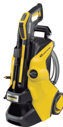
HIDRONETEJADORA POWER CONTROL K5 23005503 Pressió:145 bar. Cabal: 550 L/h. Potència 2.1 kW. Sistema Power Control: refrigerada per aire. Llança turbo i polvoritzadora Vario Power amb regulació. Sistema de detergent Plug'n Clean.
