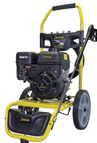
GARLAND HIDRONETEJADORA A GASOLINA 9708366 Motor 4 temps 210 cc. OHV. Pressió màxima 207 bar. Cabal màxim 600 l/h. Mànega de pressió de 7 m i pistola PRO. Bomba de llautó.
