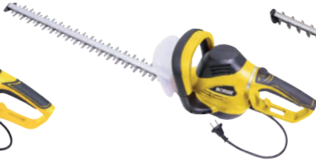
TALLABARDERS ELÈCTRIC 9704170 Potència 750 W. Longitud espasa 61 cm. Separació dents 24 mm, Empunyadura giratòria orientable: 180°. Fre mecànic. Cable de 35 cm.
