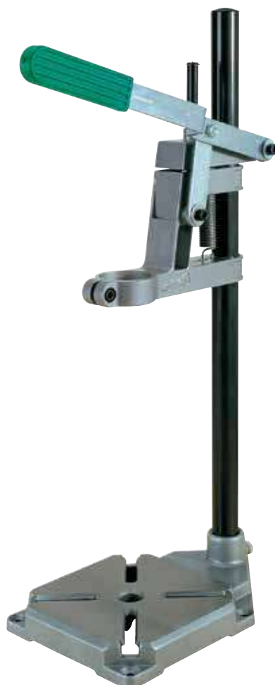
5160703 3406000. Universal, válido para la mayoría de taladros del mercado. Altura de trabajo 345 mm. Placa de fundición gris 160x160 mm. Tope de profundidad. Muelle de recuperación.
